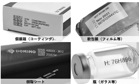
図1 カートリッジ式インクジェットプリンターの印字例
